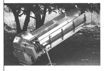
Maschinen mit 1,5 - 3,1 m<sup>3</sup> Ladevolumen für Aufbau auf Transporter
