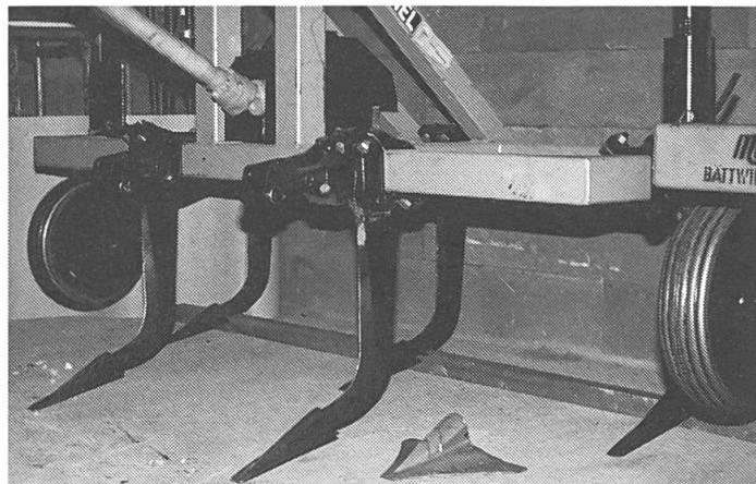
Cette sous-soleuse animée par prise de force soulève le sol en brisant plutôt intensivement les masses de terre compactées de par le mouvement des dents et des socs animés par la prise de force. Il réduit le besoin en puissance de traction avec ses conséquences sur la couche de surface.
