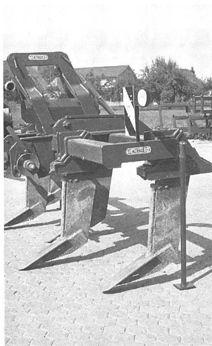
*Le décompacteur, comme les autres machines de travail du sol, doit être utilisé en condition de sol sec. L'effet d'aération et de cassure de la terre prise en masse causé par la forme de la dent et du soc en est nettement amélioré. Les dents rigides laisse une surface relativement plane, que l'on peut préparer avec un outil seul ou combiné travaillant peu profond.*
