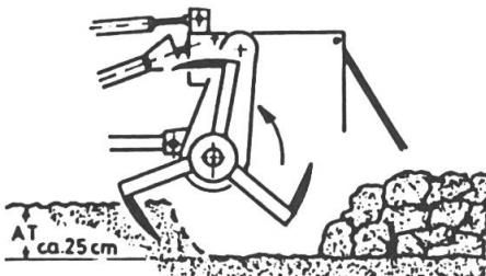
*Sur la bêcheuse rotative les outils sont fixés sur un axe horizontal en ordre décalé. La motte prélevée par l'outil coudé est rejetée contre une tôle qui ferme la machine à l'arrière. Le mouvement est similaire à celui de la fraise. Un risque évident de formation de couches de lissage lors du travail en condition de sol humide existe.*
