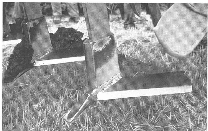
Une dent étroite équipée d'un soc en forme de patte d'oiseau large caractérise l'équipement de cette machine. Les pattes terminales de 40 cm de large découpent le sol à la profondeur de travail choisie en soulevant toute la masse de sol en exigeant un effort de traction conséquent. Elle laisse un sol presque plat, sans incorporation des résidus de récolte. Ce genre d'équipement est utilisé en combinaison avec un cultivateur lourd ou les outils de préparation à prise force.
