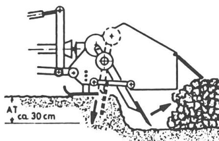
*La bêcheuse la plus répandue enfonce ses pelles, fixées à un vilebrequin, verticalement dans le sol et rejette la motte vers l'arrière en hauteur contre une tôle. Elle est spécialement adaptée en sol lourd, humide et les sols tassés et/ou défoncés par des récoltes automnales tardives. Elle laisse une structure motteuse sans horizon lissé.*
