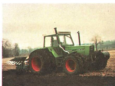
*La charrue à largeur variable: cette charrue permet d'adapter la largeur de travail hydrauliquement. Les avantages principaux sont de pouvoir s'adapter rapidement et simplement à des conditions de sol ou de parcelles changeantes (à la montée/descente, contourner des obstacles, parcelle non parallèle, alternance de type de sol). Il faut compter un prix d'environ 20% plus élevé et un entretien plus attentif.*
