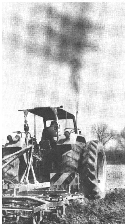
Une technique agricole respectueuse de l'environnement signifie également des moteurs avec moins de gaz d'échappement. La fumée noire est toujours un signe de mauvaise combustion. Les causes possibles sont un entretien insuffisant du moteur ou des manipulations du dispositif d'injection en carburant. Si le réglage est adéquat, le turbocompresseur de gaz d'échappement diminue la quantité de fumée noire.
