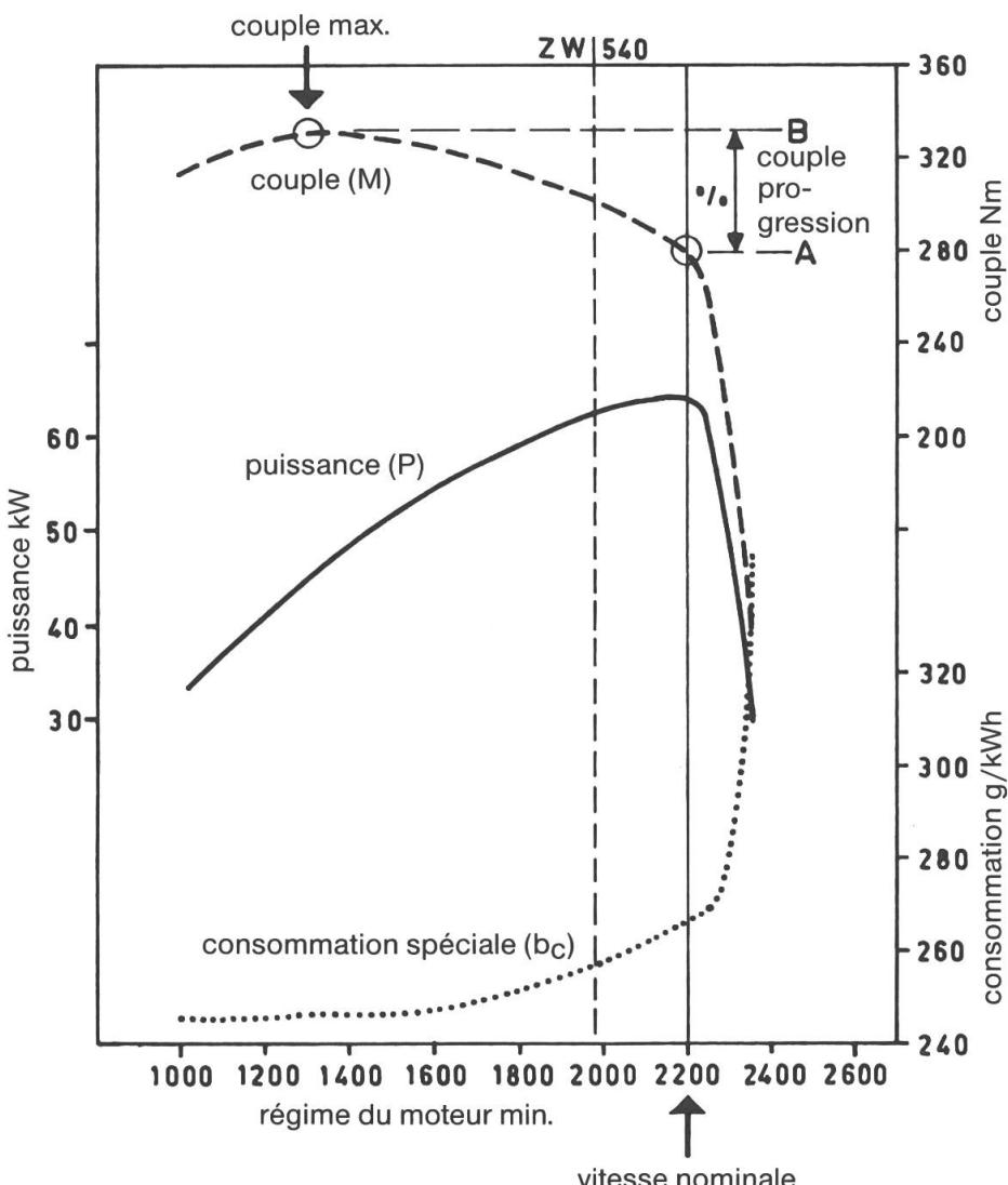
Caractéristiques d'un bon moteur de tracteur. Augmentation rapide de la courbe du couple dans la plage supérieure de régime et diminution faible du couple dans la plage de régime basse. Une augmentation de couple de plus de 20% est très bonne. La consommation de carburant spécifique est généralement la plus favorable dans le secteur où le moteur produit le plus grand moment du couple.
