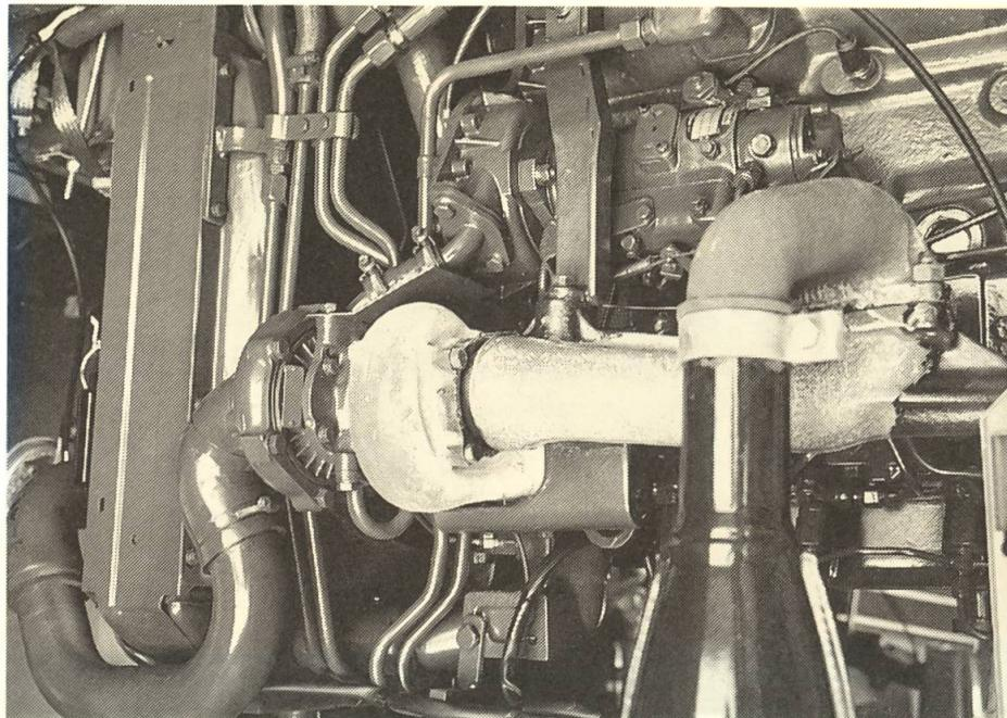
*Le turbocompresseur de gaz d'échappement exploite l'énergie contenue dans les gaz d'échappement de moteur chauds et compresse l'air d'aspiration pré-comprimé dans la chambre de combustion du moteur. Davantage d'air signifie une meilleure combustion d'une quantité de carburant plus grande et ainsi une performance plus élevée pour des gaz d'échappement demeurant constants ou améliorés.*
