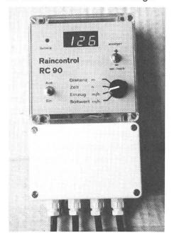
Fonctions: mesure, affiche en chiffre digitaux et règle continuellement la vitesse d'entrainement du tuyau comme le RC88. En plus le RC90 affiche la longueur du tuyau dérouleur et indique le temps nécessaire pour l'enroulement. Le temps de pré-arrosage et le temps d'après-arrosage peuvent aussi être réglés automatiquement.
