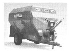
De plus, les mélangeuses avec fraise désileuse sont aujourd'hui montées sur un châssis indépendant qui permet le pesage du fourrage désilé alors que la machine est à terre.
