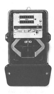
Les compteurs pour les exploitations agricoles ont deux concepts de mesure différents. A gauche, le compteur dit à double tarif, qui contient deux indicateurs permettant de mesurer, l'un la consommation au haut tarif (indicateur 1) et l'autre la consommation au bas tarif (indicateur 2). Le compteur à indicateur de puissance à droite mesure, outre la consommation d'électricité, le besoin de puissance maximal en kilowatt (kW) par tranches de quart d'heure (indicateur en-haut à gauche).
