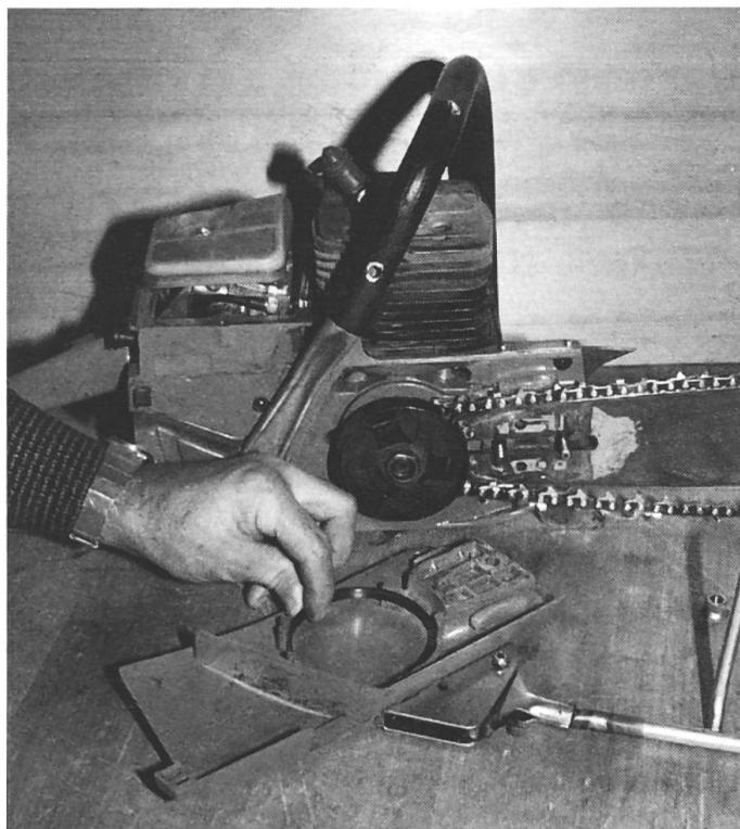
Examiner le degré d'usure entre le pouce et l'index et comparer le milieu du ruban avec les extrémités. Si l'usure est perceptible ou si des fissures dues à l'échauffement apparaissent, il faut immédiatement faire remplacer le ruban par un atelier spécialisé.
