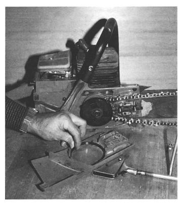
Examiner le degré d'usure entre le pouce et l'index et comparer le milieu du ruban avec les extrémités. Si l'usure est perceptible ou si des fissures dues à l'échauffement apparaissent, il faut immédiatement faire remplacer le ruban par un atelier spécialisé. Photo: F. Brügger
