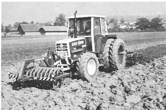
Fig. 3: Le rouleau tasse-avant émiette et égalise le sol entre les roues du tracteur et occasionne, en plus, une certaine pression, soit superficielle (rouleau spirale, à droite), soit en profondeur (rouleau squelette, à gauche). La pression dépend du genre de construction et du poids propre de l'outil et peut être renforcée par un vérin hydraulique à double effet. La force de levage exigée du système hydraulique frontal correspond plus ou moins au poids du rouleau multiplié par le facteur 1,5.
