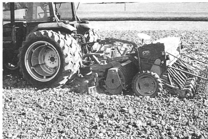
Fig. 7: La herse alternative laisse un sol bien nivelé et se distingue par de modestes besoins en puissance. A gauche: le rouleau packer, bien dimensionné, contribue à un émiettement ultérieur et au raffermissement du sol. A droite: dans des conditions favorables, cette performante combinaison d'outils permet d'effectuer la préparation du lit de semences et le semis en une seule opération.
