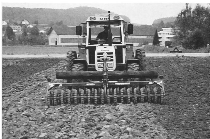
Fig. 12: Une comparaison de rouleaux, effectuée sur un sol limoneux mi-lourd et avec du seigle d'automne, n'a pas donné de différences de rendement. Le rouleau squelette, le rouleau spirale ainsi que le rouleau à prismes porté à l'avant (à gauche) se valaient. La combinaison associant, sur un même bâti, à un rouleau squelette à deux rangées un rouleau crosskill (à droite) permettait d'effectuer le labour et la préparation du lit de semences en une seule opération. Le temps supplémentaire exigé pour la disposition de cette combinaison était d'environ 25 minutes par champ, et le labour exigeait 20% de force de traction en plus.
