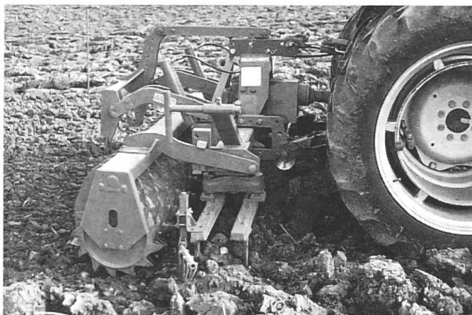
Fig. 7: La herse alternative laisse un sol bien nivelé et se distingue par de modestes besoins en puissance. A gauche: le rouleau packer, bien dimensionné, contribue à un émiettement ultérieur et au raffermissement du sol. A droite: dans des conditions favorables, cette performante combinaison d'outils permet d'effectuer la préparation du lit de semences et le semis en une seule opération.
