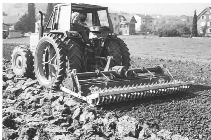
Fig. 11: L'humidité du sol constitue le facteur décisif pour le travail de préparation. Dès que le sol est trop humide, le rouleau cage commence à coller; ainsi la préparation d'un lit de semences devient impossible, ce qui est alors un avantage (à droite, en haut). Dans des conditions favorables quant à l'humidité du sol, il vaut mieux choisir le rouleau cage (à gauche) que le rouleau packer. Le rouleau packer avec ses décroisseurs peut pratiquement être utilisé dans n'importe quelles conditions et se prête ainsi à des combinaisons d'outils (à droite, en bas).
