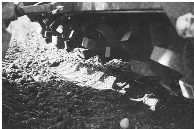
Fig. 8: En utilisant des matériels animés à la prise de force, il faut augmenter la vitesse d'avancement tout en diminuant le régime du rotor; cela afin de réduire l'intensité du travail et de prévenir une dégradation de la structure du sol, particulièrement des dommages peu évidents tels qu'un état interne compact des agrégats et la destruction des enveloppes humiques. A gauche: herse rotative à axes verticaux. A droite: herse rotative à axe horizontal (en haut); fraise (en bas).
