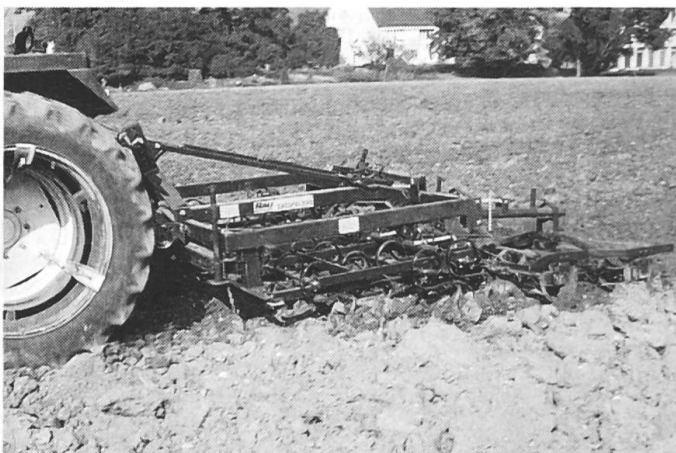
Fig. 4: Avec le vibroculteur, l'outil standard, il faut souvent deux passages au minimum. L'intervalle de ressuyage entre les différents passages doit permettre un émiettement naturel optimal (éviter la dégradation du profil par des passages trop nombreux).
