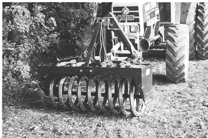
Fig. 3: Le rouleau tasse-avant émiette et égalise le sol entre les roues du tracteur et occasionne, en plus, une certaine pression, soit superficielle (rouleau spirale, à droite), soit en profondeur (rouleau squelette, à gauche). La pression dépend du genre de construction et du poids propre de l'outil et peut être renforcée par un vérin hydraulique à double effet. La force de levage exigée du système hydraulique frontal correspond plus ou moins au poids du rouleau multiplié par le facteur 1,5.
