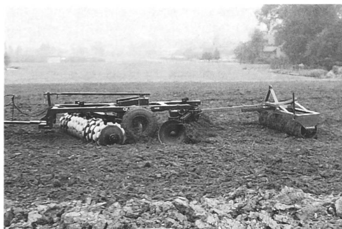
Fig. 5: La préparation du lit de semences au moyen de la herse à disques combinée à un rouleau cannelé est possible, mais peu usuelle. A défaut d'une couverture du sol, les grosses mottes servent de protection contre le vent et l'eau.
