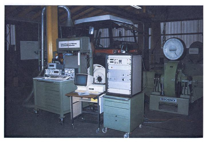
**Maintenant:** Le banc d'essai pour tracteurs, mis la première fois en service en 1987 à la FAT est adapté régulièrement aux nouvelles techniques. Des appareils de mesure modernes ainsi que le traitement électronique des données rendent possible des travaux rapides ainsi que la mise en valeur immédiate des résultats.
