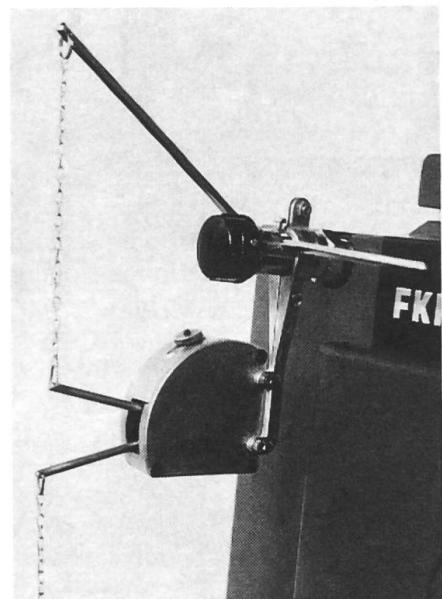
L'économiseur Awina sera monté sur le régulateur de tirage existant ou fixé directement au manteau de la chaudière. Tous les éléments nécessaires font partie de la fourniture. Le montage est facile.
