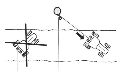
Lors du travail au treuil sur une côte, il faut dévier le câble en amont au moyen d'une poulie.
