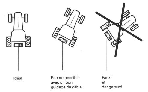
Lors du travail au treuil, l'angle formé par l'axe longitudinal du trac-
