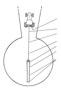
Protection du machiniste contre les coups provoqués par le câble qui se détend, l'extrêmité du câble, le crochet ou les attaches.
