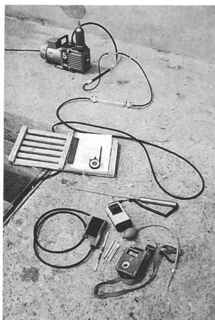
Fig. 2: Quelques-uns des instruments de mesure utilisés. Au second plan, prélèvement de gaz pour échantillonnage au chromatographe en phase gazeuse, au premier plan un tube fumigène, un thermomètre et un appareil de mesure du H 2 S.
