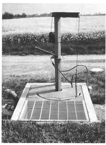
Un brasseur fixe, maniable de l'extérieur, une protection bien conçue des bouches d'aération et des éléments de pompage solides contribuent à éliminer les riques d'accidents et facilitent les travaux.
