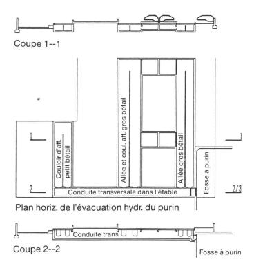
Dispositif d'arrêt des gaz entre l'étable et la fosse à purin – syphon permettant l'arrêt des gaz lors de la vidange des canaux dans la fosse: les canaux placés sous les caillebotis ou sous les grilles, à évacuation continue ou intermittente, sont vidés dans un canal transversal ayant à son extrémité un muret de retenue. Le lisier s'écoule dans la fosse en passant par un syphon dont la «bavette-syphon» coupe les gaz.
