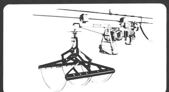
Voici la première griffe à fourrages commandée électroniquement pour la préparation du fourrage. Une seule pression sur un bouton et vous transportez le fourrage désiré. Sans changer de place et par simple réglage, vous pouvez choisir 4 postes de chargement sur le tas (sur la meule) et jusqu'à 15 postes de déchargement automatiques. Grâce à un nouveau système d'entraînement, des élévations de 30° (52%) ne posent aucun problème. C'est bien entendu une nouveauté Zumstein!
