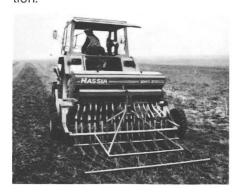
Les couteaux en étoile rotatifs s'adaptent aisément aux terrains inégaux et, grâce à une suspension spéciale, garantissent également une découpe optimale des sols durs.
