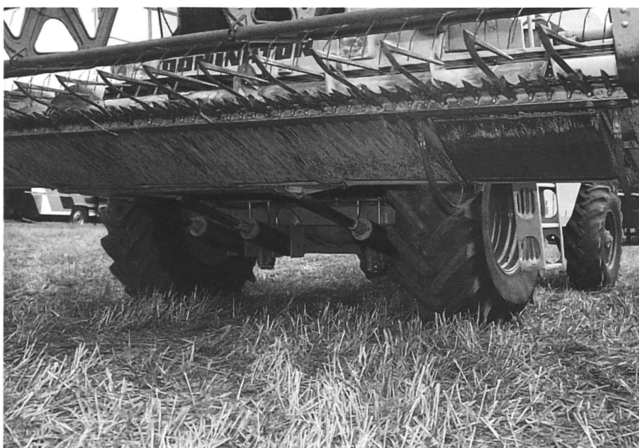
Guidage de la barre de coupe AUTO CONTOUR, effectuée par des palpeurs électroniques mesurant hauteur, déclivité et délestage du sol.
