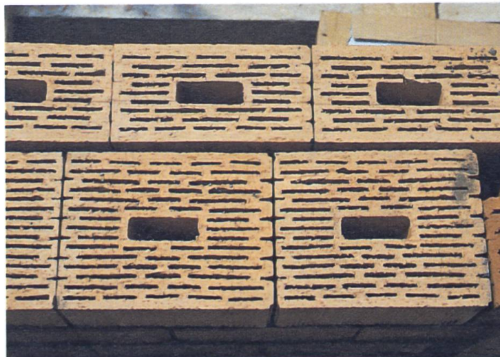
OPTITERM — Une nouvelle génération de briques avec une meilleure isolation thermique.
