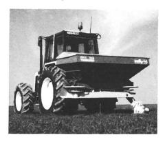
En outre, sur le DPAX, le débit est strictement proportionnel à la vitesse d'avancement, grâce à une roue à barrettes qui, en roulant sur le sol, transmet son mouvement aux tapis d'amenage.
