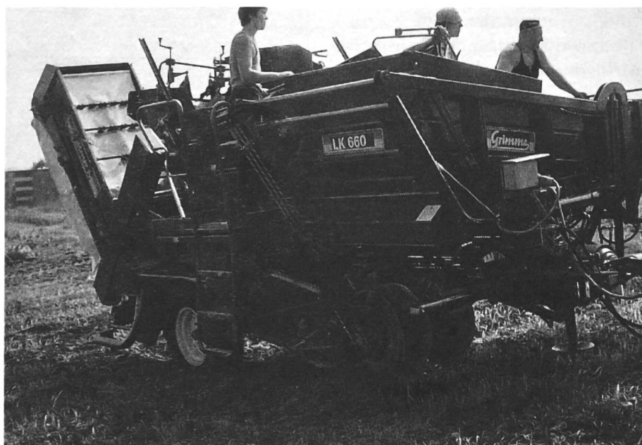
b) Grimme LK 660 est une arracheuse totale avec organe d'arrachage déporté et disposition symétrique du ruban de criblage (construction en deux étages). La LK 650 et la SL 750, provenant également de Grimme, représenté en Suisse par Grunder SA à Lucens VD , ont aussi été testées.
