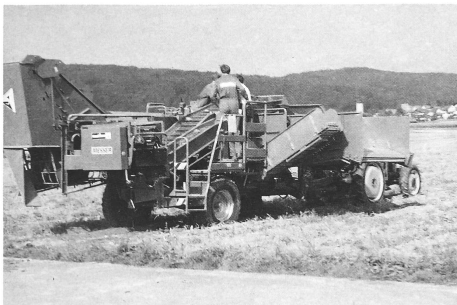
d) Wuehlmaus 1733 CH était la plus lourde des arracheuses combinées testées dans le cadre des essais comparatifs. Comme Wisent, elle est équipée d'un racleur rotatif triple. L'importateur, Messer AG à Niederbipp SO , a remplacé la 1733 CH par la 1750 CH, un nouveau modèle du même type de construction.
