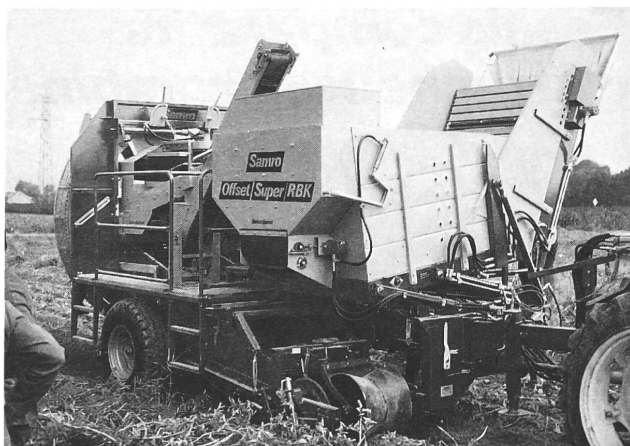
a) Samro Offset équipé d'un réservoir supplémentaire sur la trémie à sol roulant pour tubercules de petit calibre et de rebut. Par ailleurs, les arracheuses combinées Samro SC et Samro Master en provenance de la maison Samro Bystronic à Burgdorf ont également été testées.
