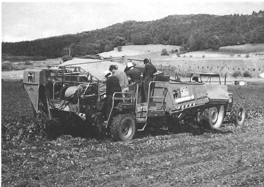
c) Wisent Medium S est une arracheuse combinée avec organe d'arrachage déporté (type de construction à un étage). La nouveauté de cette marque – elle est importée par Mueller Machinen AG, Bättwil BL – est l'intégration de la récolte des pommes de terre de petit calibre et de rebut dans la trémie à sol roulant.
