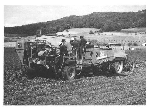
c) Wisent Medium S est une arracheuse combinée avec organe d'arrachage déporté (type de construction à un étage). La nouveauté de cette marque – elle est importée par **Mueller Machinen AG, Bättwil BL** – est l'intégration de la récolte des pommes de terre de petit calibre et de rebut dans la trémie à sol roulant.
