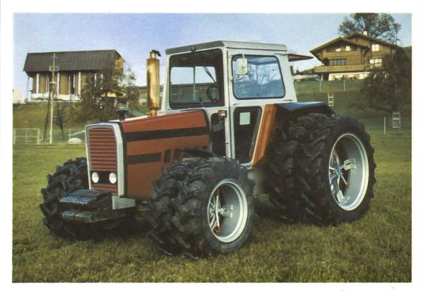
Un tracteur moderne équipé de 4 paires de roues jumelées Müller. La nouvelle technique de travail pour ménager le sol.
