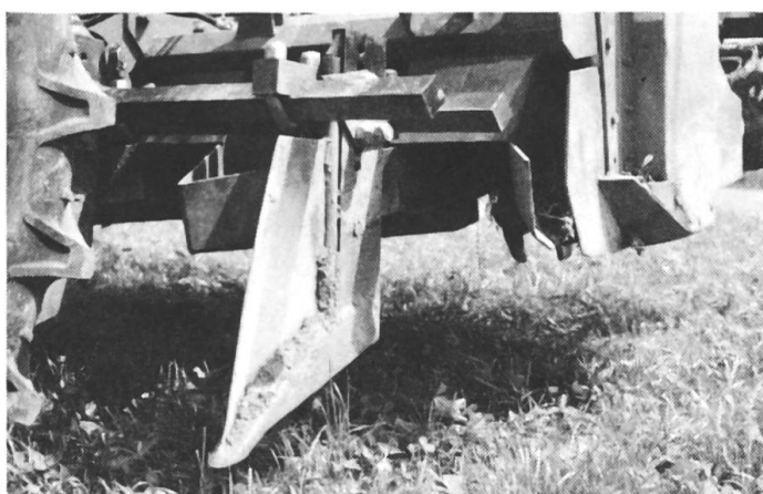
Fig. 9: Semis de maïs dans une prairie fraîchement fauchée (ensilage). La fraise qui travaille une bande de 30 cm de large est précédée par une dent rigide pour décompacter le sol sur une profondeur de 25 cm. Le semis, l'épandage d'engrais et le traitement herbicide localisé sont effectués lors d'un deuxième passage.
