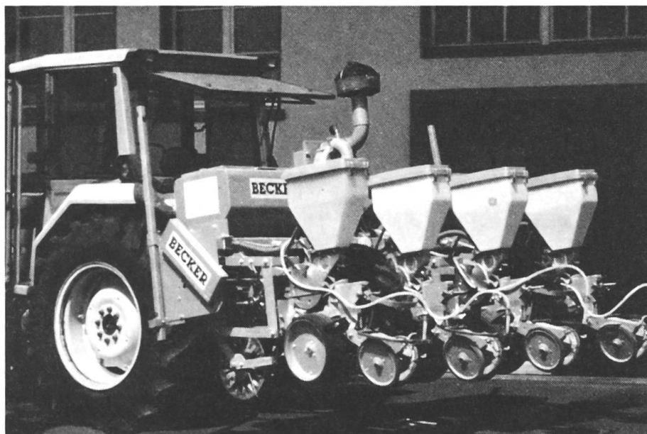
Fig. 8: Semoir monograine pour semis direct, équipé de disques coupants, socs à disques munis de roues pour le contrôle de profondeur, et roues plombeuses en V. Cette machine permet de semer dans une litière, sur un labour ou dans un sol préparé de façon traditionnelle.
