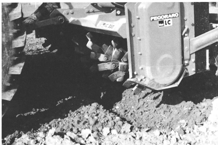
Fig. 4: Herse rotative à axe horizontal. Les dents du rotor émiettent et incorporent les résidus végétaux et détruisent les mauvaises herbes.
