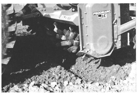
Fig. 4: Herse rotative à axe horizontal. Les dents du rotor émiettent et incorporent les résidus végétaux et détruisent les mauvaises herbes.
