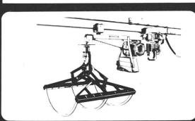
Voici la première griffe à fourrages commandée électroniquement pour la préparation du fourrage. Une seule pression sur un bouton et vous transportez le fourrage désiré. Sans changer de place et par simple réglage, vous pouvez choisir 4 postes de chargement sur le tas (sur la meule) et jusqu'à 15 postes de déchargement automatiques. Grâce à un nouveau système d'entraînement, des élévations de 30° (52%) ne posent aucun problème. C'est bien entendu une nouveauté Zumstein!
