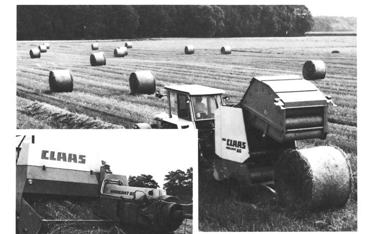
Grande capacité aussi pour andains larges et irréguliers avec un robuste peigne ameneur derrière le pick-up. Dans le foin, la paille ou silage, CLAAS presse le tout très fortement; des balles solides, serrées à l'intérieur et très dures à l'extérieur. Une haute sécurité, peu d'entretien et une longue durée imprègnent la rentabilité bien connue de CLAAS.
