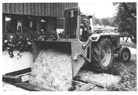
Fig. 19: Chargeur arrière muni d'une pelle pour le remplissage d'une trémie à bois déchiqueté.
