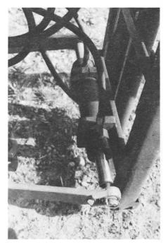
Fig. 5: Dispositif de poussée latérale (avec ce système, le lève-palettes est déplacé par rapport à l'attelage troispoints).
