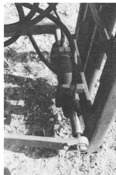
Fig. 5: Dispositif de poussée latérale (avec ce système, le lève-palettes est déplacé par rapport à l'attelage trois-points).
