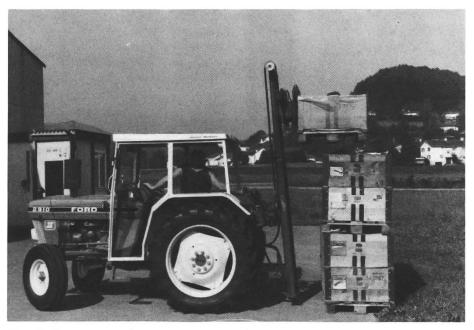
Fig. 17: Chargeur arrière empilant des paloxes.
