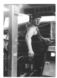
Fig. 14: Lors de la manœuvre en marche arrière, le conducteur ne dispose souvent que d'une main pour guider le volant.
