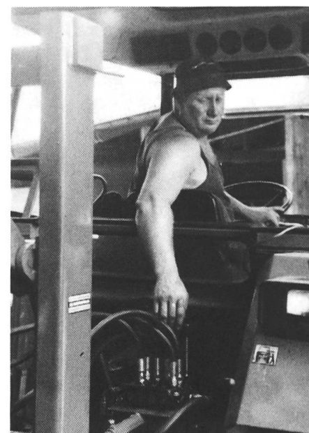
Fig. 14: Lors de la manœuvre en marche arrière, le conducteur ne dispose souvent que d'une main pour guider le volant.
