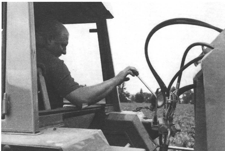
Fig. 7: Le groupe de commandes hydrauliques est en général monté sur le lève-palettes, côté du conducteur.
