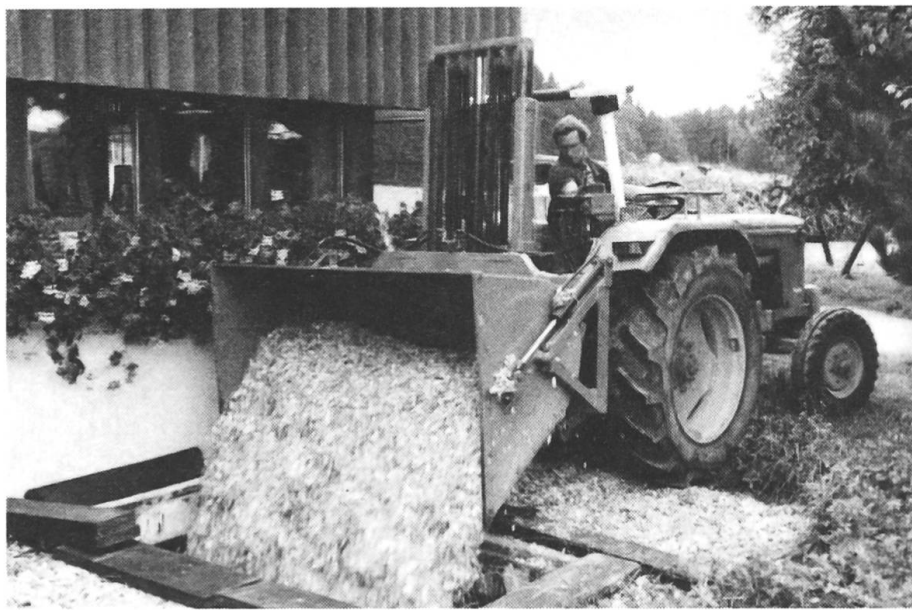
Fig. 19: Chargeur arrière muni d'une pelle pour le remplissage d'une trémie à bois déchiqueté.
