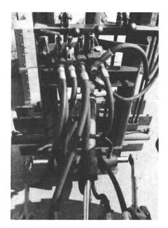
Fig. 18: La visibilité depuis le siège du tracteur sur la fourche est fortement limitée.
