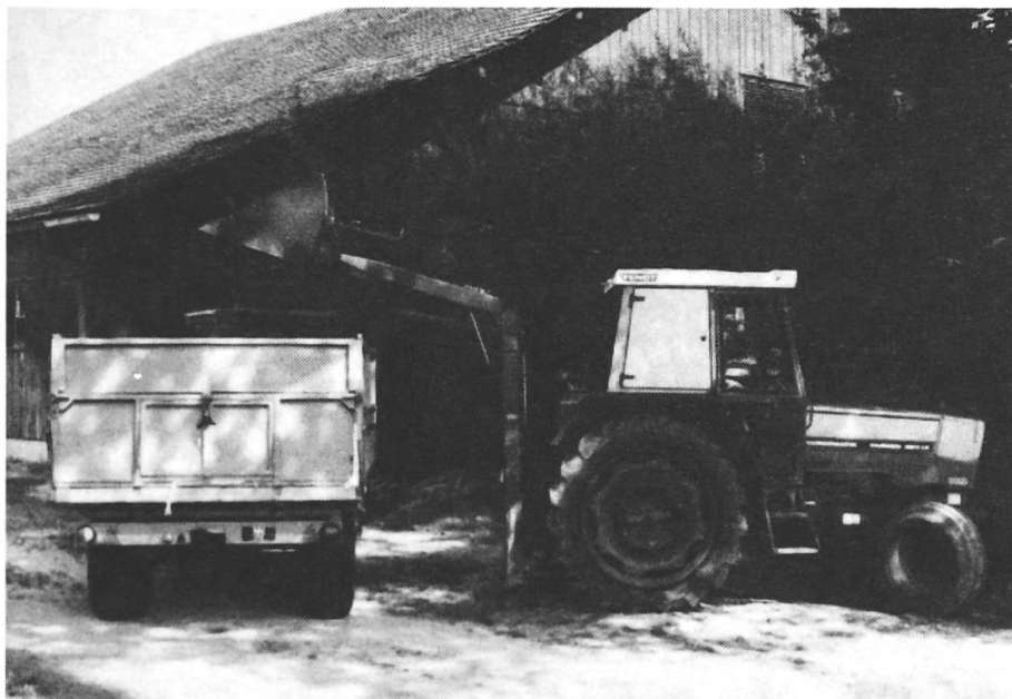
Fig. 21: Chargeur arrière muni d'une pelle pour le chargement de gravier.
