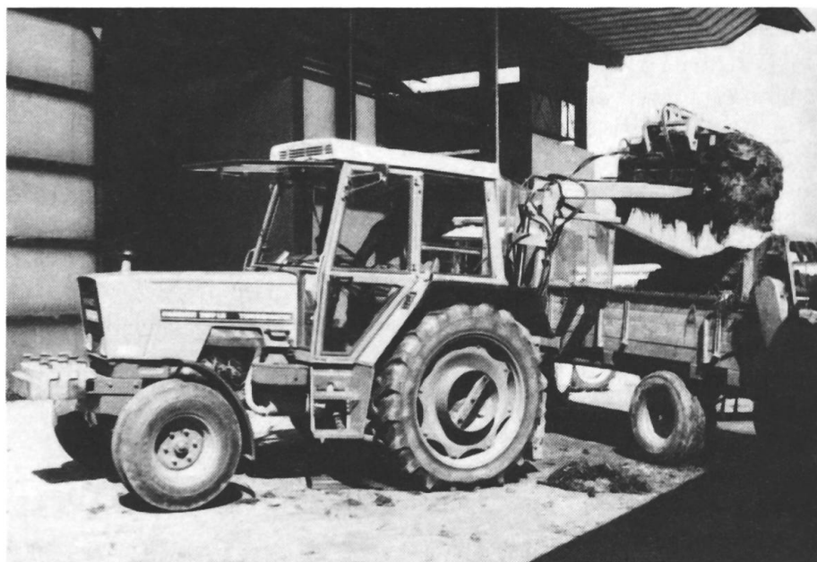
Fig. 20: Chargeur arrière muni d'une pince crocodile pour sortir le fumier d'une étable à stabulation libre.
