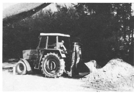
Fig. 3: Chargeur arrière avec pelle.
