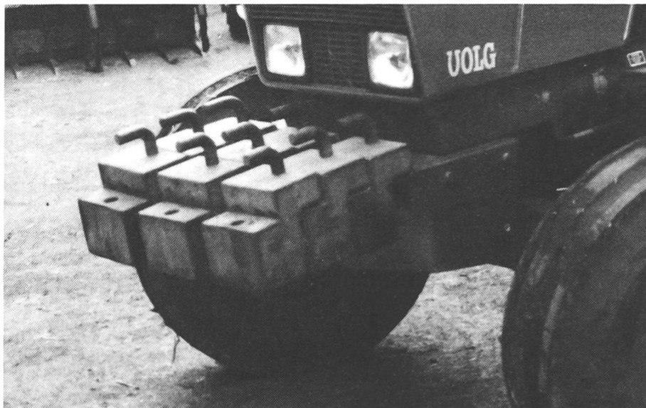
Fig. 13: Un lestage bien calculé de l'essieu avant facilite la manœuvrabilité.
