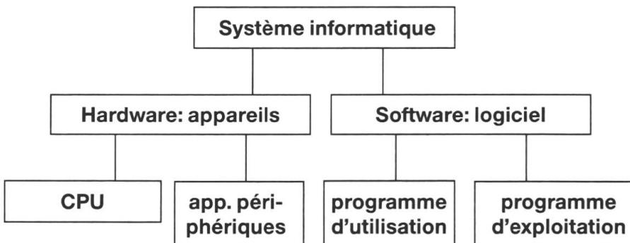
Le terme «Hardware» signifie matériel et désigne tous les appareils qui font partie d'un système informatique, c'est-à-dire, la partie centrale, CPU (Central processing unit) avec la mémoire principale, les appareils périphériques (imprimante, moniteur et clavier).
