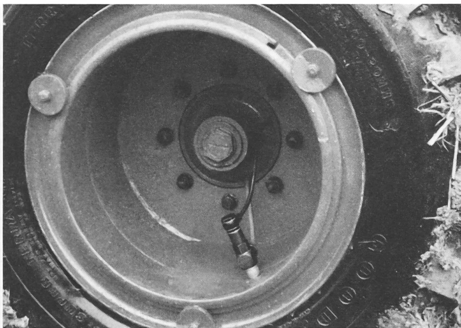
La soupape à air comprimé disposée à l'intérieur de la jante comporte deux aménagements d'air: l'une pour la distribution, l'autre pour l'alimentation.
