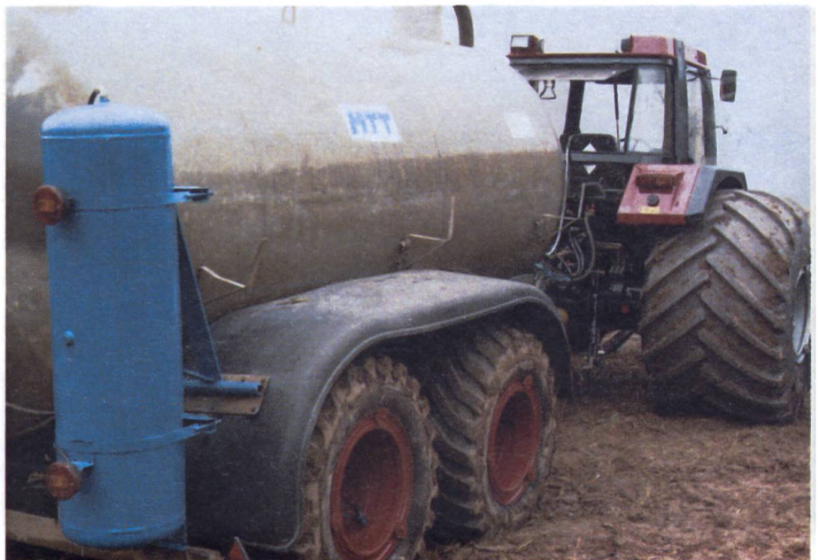
Le passage constant de la route aux champs justifie pleinement l'installation de réglage pour la pression des pneus. A gauche, se trouve l'un des deux compresseurs, d'une capacité de 160 l chacun.
