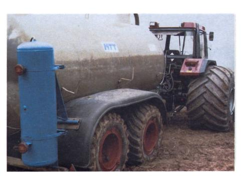
Le passage constant de la route aux champs justifie pleinement l'installation de réglage pour la pression des pneus. A gauche, se trouve l'un des deux compresseurs, d'une capacité de 160 l chacun.
