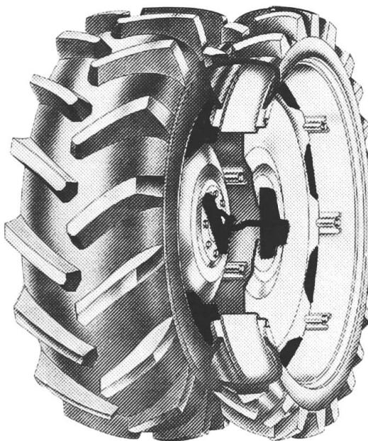
Grâce au système AW d'accouplement des roues jumelées GS. Que la roue montée sur votre tracteur soit large ou étroite, l'autre roue se fixe automatiquement et est immédiatement utilisable comme roue jumelée sans modifications désagréables. Notre principe est sans pareil sur le marché européen et des attestations internationales le prouvent.
