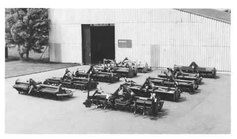
Fig. 1: Au cours des essais compartifs, l'effet d'émiettement et d'enfouissement ainsi que les besoins en puissance à la prise de force ont été testés sur neuf herses rotatives à axe horizontal. En outre, les donées techniques de chaque machine ont été enregistrées.
