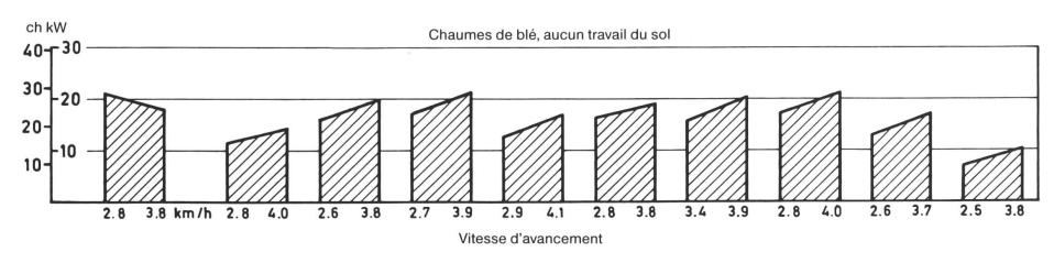
Fig. 6: Besoins en puissance à la prise de force lors d'utilisations différentes.
