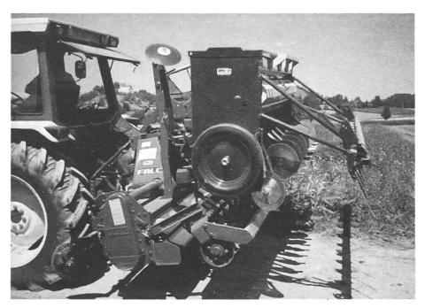
Fig. 8: Un attelage trois points arrière avec relevage hydraulique supprime le porte-à-faux dû au semoir, ce qui permet de travailler avec une puissance de relevage moins importante du tracteur.
