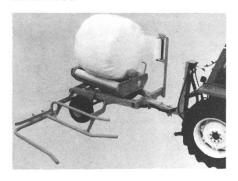
Les enrubanneuses sont construites de telle façon qu'elles s'adaptent également aux tracteurs de petite taille: le modèle à trois points d'appui peut être posé sur le sol, les deux autres modèles sont traînés. Le modèle G 90 S est muni d'une fourche de chargement intégrée, critère important pour un agriculteur qui a peu de personnel.
