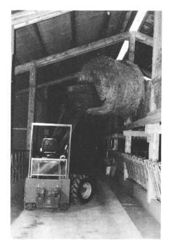
Fig. 6: Un chargeur automoteur avec direction articulée permet de placer une balle ronde sur ce faux-plafond à partir du couloir d'affouragement. Lors des travaux d'empilage et de chargement avec des machines à direction articulée, les pneumatiques jumelés diminuent le risque de renversement latéral de la machine.
