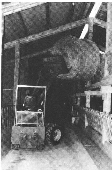
Fig. 6: Un chargeur automoteur avec direction articulée permet de placer une balle ronde sur ce faux-plafond à partir du couloir d'affouragement. Lors des travaux d'empilage et de chargement avec des machines à direction articulée, les pneumatiques jumelés diminuent le risque de renversement latéral de la machine.
