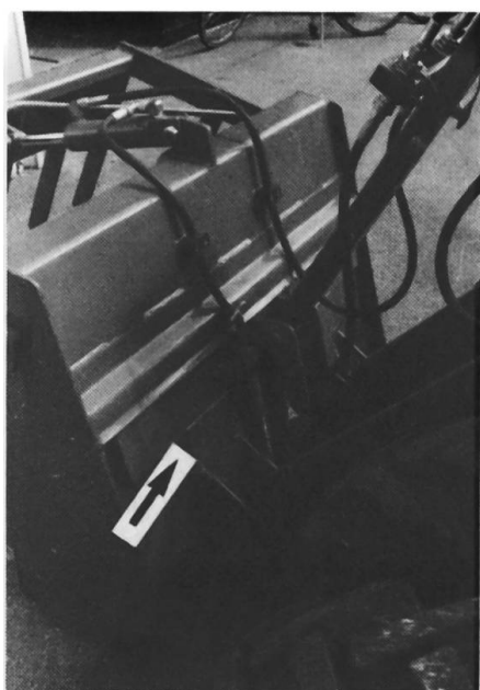
Fig. 9: Un cadre d'accrochage avec système de verrouillage facilite l'échange rapide d'outils.
