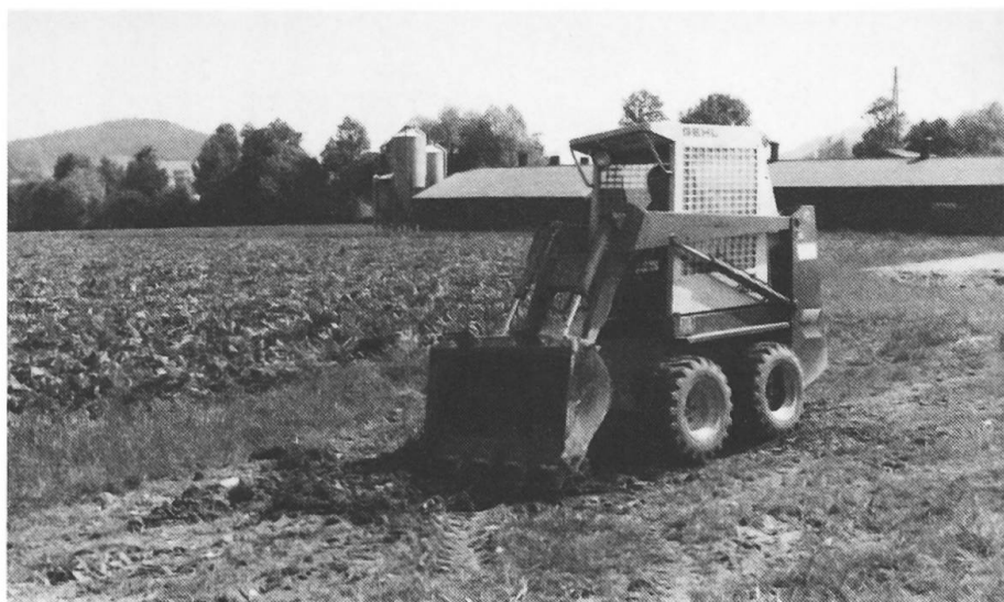
Fig. 8: Pour des travaux d'excavation, il faut prévoir des dents excavatrices. Mais le poids relativement faible de la machine représente un inconvénient si on veut entreprendre des travaux d'excavation très durs.
