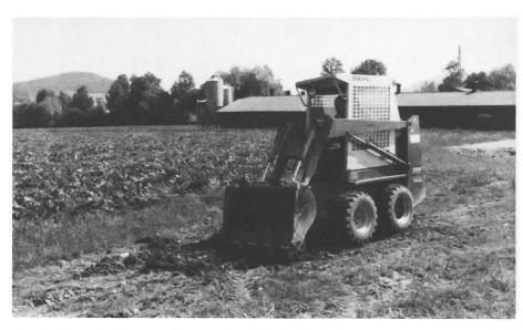
Fig. 8: Pour des travaux d'excavation, il faut prévoir des dents excavatrices. Mais le poids relativement faible de la machine représente un inconvénient si on veut entreprendre des travaux d'excavation très durs.
