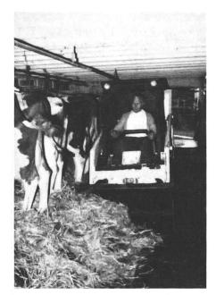
Fig. 5: Chargeur compact utilisé pour sortir le fumier d'une étable à stabulation entravée. Ici, il faut tenir compte avant tout des facilités de travail. Les dalles de fumier devraient être de préférence très plates. De larges portes et une paroi verticale à l'extrémité de la dalle à fumier seraient d'un grand avantage.
