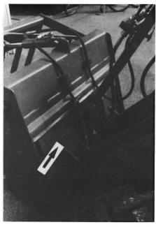
Fig. 9: Un cadre d'accrochage avec système de verrouillage facilite l'échange rapide d'outils.
