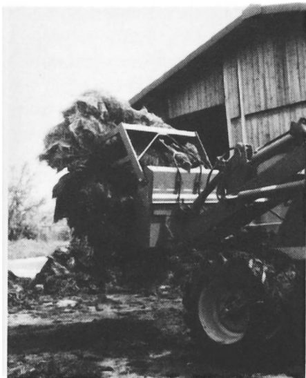
Fig. 7: La contre-griffe de la fourche à fumier (fourche croco) permet de bien la remplir et maintient le fumier fermement jusqu'à l'épandeur.
