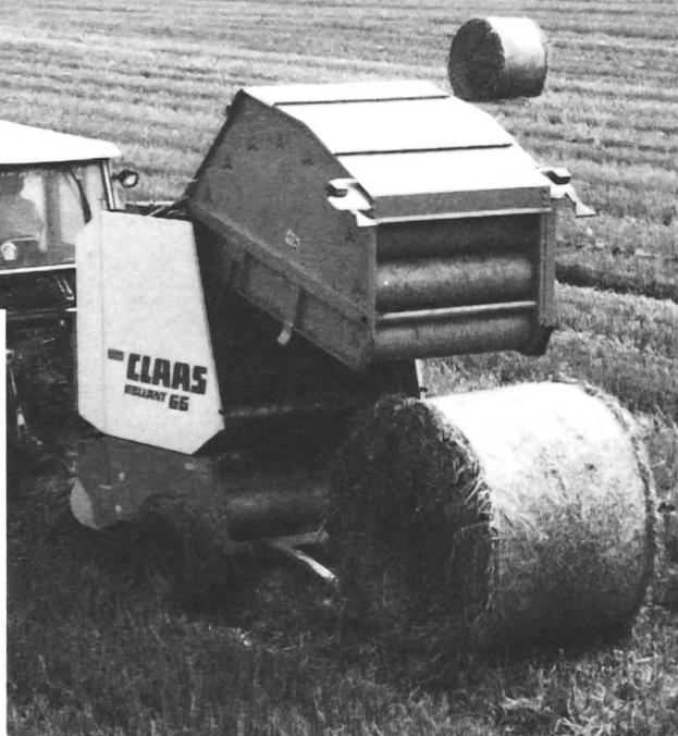
Grande capacité aussi pour andains larges et irréguliers avec un robuste peigne ameneur derrière le pick-up. Dans le foin, la paille ou silage, CLAAS presse le tout très fortement; des balles solides, serrées à l'intérieur et très dures à l'extérieur. Une haute sécurité, peu d'entretien et une longue durée imprègnent la rentabilité bien connue de CLAAS.
