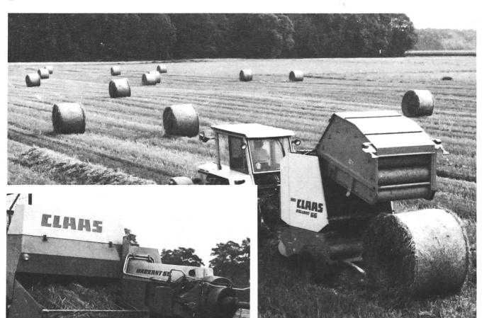
Grande capacité aussi pour andains larges et irréguliers avec un robuste peigne ameneur derrière le pick-up. Dans le foin, la paille ou silage, CLAAS presse le tout très fortement; des balles solides, serrées à l'intérieur et très dures à l'extérieur. Une haute sécurité, peu d'entretien et une longue durée imprègnent la rentabilité bien connue de CLAAS.
