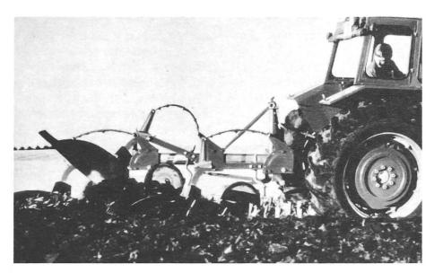
Fig. 5: Charrue avec dispositif de sécurité nonstop mécanique. Photo d'usine Kverneland
