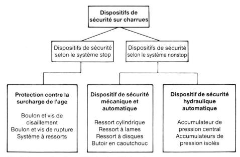
Fig. 1: Aperçu des dispositifs de sécurité des charrues.
