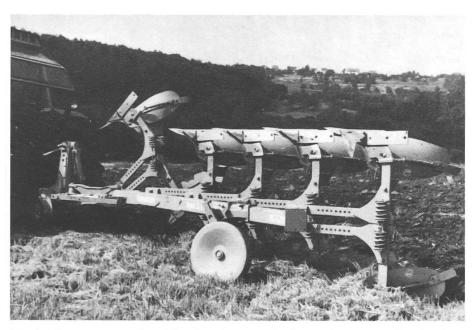
Fig. 3: Charrue avec sécurité mécanique contre la surcharge nonstop tandem. Photo de l'usine Lemken
