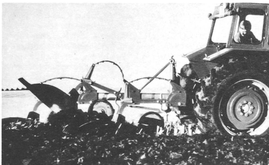
Fig. 5: Charrue avec dispositif de sécurité nonstop mécanique. Photo d'usine Kverneland
