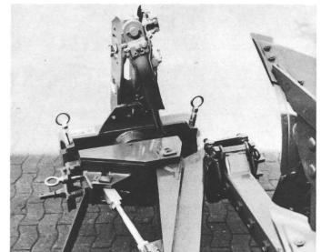
Fig. 2: Genouillère avec plaque à articulation quadruple. A gauche: photo d'usine Krone. A droite: photo d'usine Rabewerk
