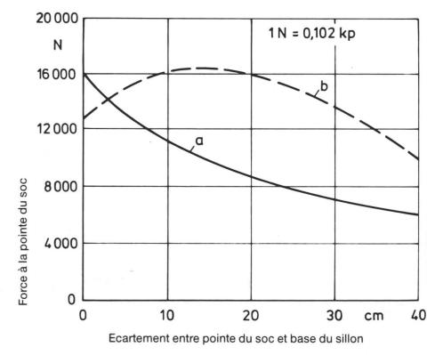
Fig. 7: Tracé de la force de déclenchement respectivement rappel à la pointe du soc en fonction de la hauteur de relevage avec des dispositif de sécurité nonstop.
