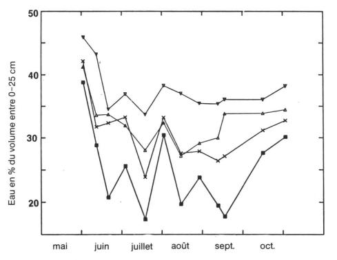
Illustration 2: Evolution des teneurs volumétriques en eau du sol dans la bande d'un verger de pommiers à Guettingen (mai à octobre 1989) entre 0-25 cm de profondeur. En plus du traitement herbicide (là où les conditions les plus sèches règnaient) et du sarclage, la bande fut également recouverte avec un paillage plastique (Mypex) et avec des écorces grossières de conifères.
