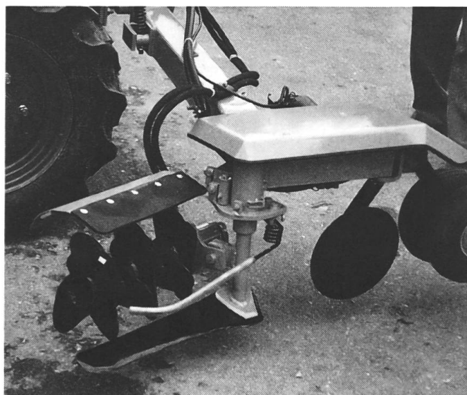
Lame sous-soleuse R.P.M. avec soc plat («lame») et bras tâteur. Le système de scarification sur la lame améliore considérablement l'efficacité contre les mauvaises herbes.
