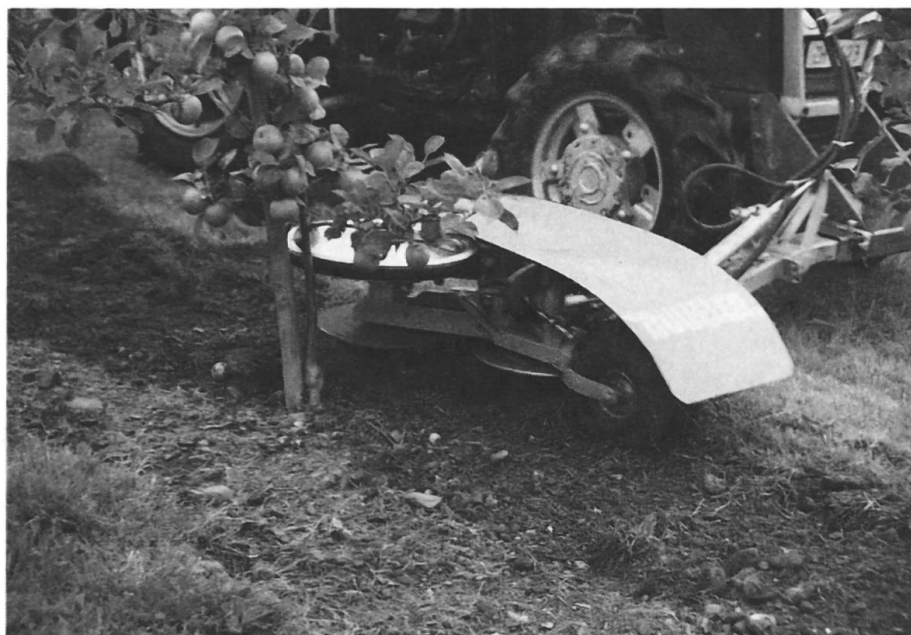
Emotteuse BN2 Buecheler. Un tâteur à roues guide le deuxième disque de sarclage autour des troncs.
