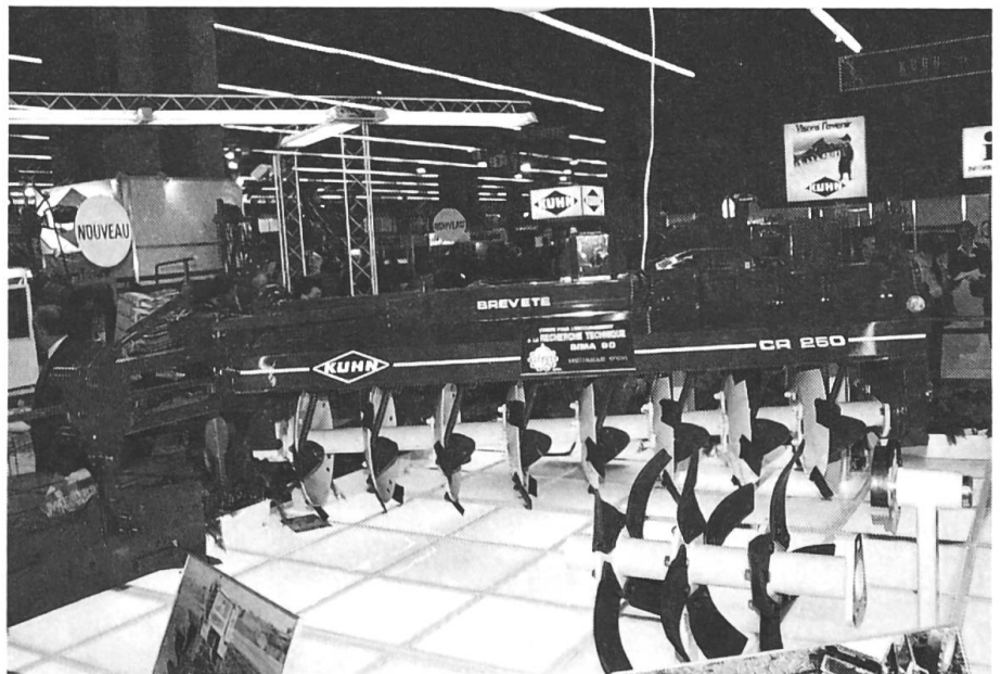
«Charrue-rotor». Grâce au mouvement du rotor animé par la prise de force (avec une largeur de travail allant jusqu'à 2.50 m), un tracteur, de puissance moyenne, pourra être employé sans risques de dommages causés par glissement ou patinage.
