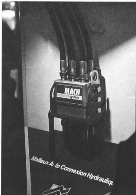
Unité d'accouplement permettant de relier simultanément 5 conduites hydrauliques et 6 conduites électriques.
