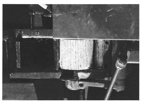
Fig. 2: Processeur de grains, vu d'en haut. Les deux rouleaux tournent à des vitesses différentes. Le fourrage est amené entre les deux rouleaux, l'amenée d'air entre par l'orifice de gauche.
