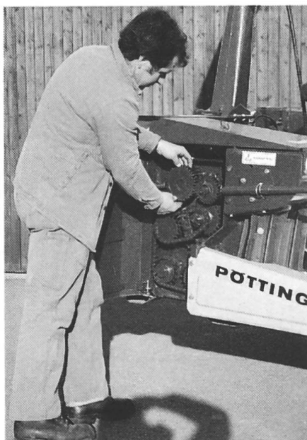
Fig. 8: A gauche: réglage simple concernant la longueur, en échangeant les deux pignons. A droite: l'échange des deux roues dentées baignant dans la graisse est une solution malaisée.
