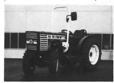
d'échappement vers le bas et des nouvelles plaques de contre-poids de 25 kg la pièce. A part la boîte de vitesses standard à 12/4 rapports, il existe des versions combinées à inverseur et super-rampantes.
