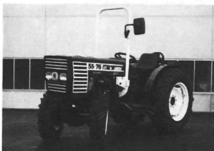
d'échappement vers le bas et des nouvelles plaques de contre-poids de 25 kg la pièce. A part la boîte de vitesses standard à 12/4 rapports, il existe des versions combinées à inverseur et super-rampantes.
