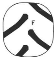
Fig. 2: La pression spécifique sur le sol, respectivement la pression sur la surface de contact K = G : F n'est qu'une mesure du risque de tassement à la surface.
