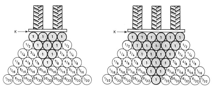
Fig. 3: Propagation de la pression pour une pression sur la surface de contact constante et un poids différent. Plus le poids est grand, plus l'effet en profondeur est grand.
