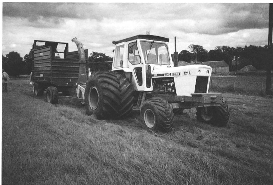
Fig. 1: Si une augmentation de poids est inévitable, les pneumatiques doivent s'accroître de manière plus que proportionnelle.
