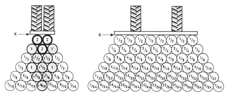
Fig. 4: Propagation minimale de la pression pour un poids constant par augmentation de la surface de contact des pneus, c'est-à-dire utiliser des pneus larges, c'est la dévise.
