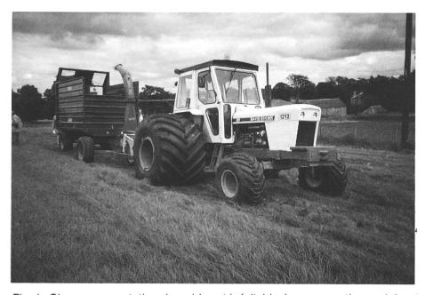
Fig. 1: Si une augmentation de poids est inévitable, les pneumatiques doivent s'accroître de manière plus que proportionelle.
