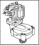
Démultiplicateur pivotant qui ne tourne pas en pente. Avec lubrification permanente. Démarrage souple et freinage en douceur.
