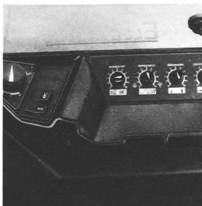
Réglage électronique du relevage hydraulique (CER)
