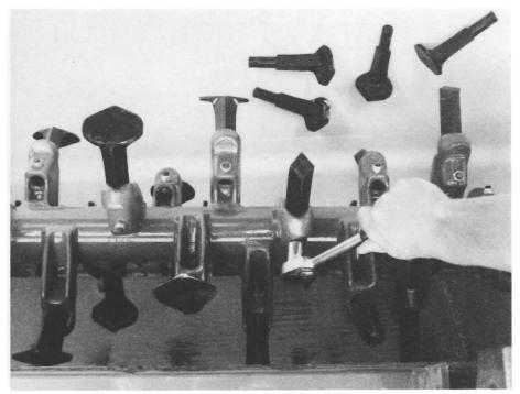
Dans la barre porte-dent du rotor, il est possible de fixer deux types de dent différents:
