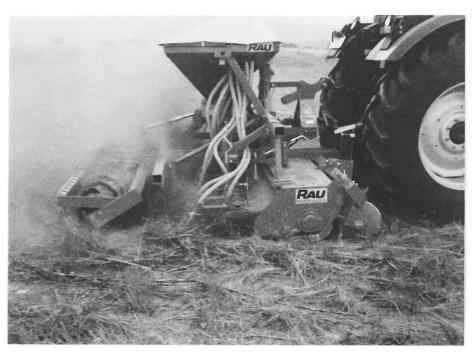
Semis dans le «courant» de terre sans risque de bourrage avec la machine de mise en place en un passage Rotosem. Les tuyaux de distribution de la semence sont disposés de manière décalée sur deux rails. Le passage des résidus de récolte n'est pas entravé. Les semences sont couvertes fiablement de terre.
