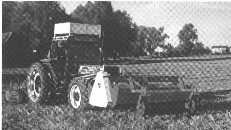
Moreau: Ce broyeur fonctionne au moyen d'un rotor très rapide qui détruit finement la feuille de la betterave et la dépose entre les lignes au moyen d'une tôle de guidage. La machine sera présentée pour la première fois à l'Agritechnica de Francfort.
