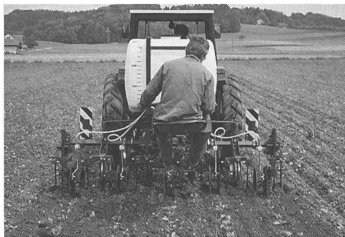
Fig. 2: La sarcleuse à socs I permet d'obtenir une bonne qualité de travail dans les sols tourbeux ou dans les sols minéraux fort pierreux. Les sarcleuses munies de socs en patte d'oie, montés sur ressorts, ont un excellent effet de «mulching» et d'autonettoyage (à droite: sarcleuse à socs II, peut être également utilisée dans le maïs).
