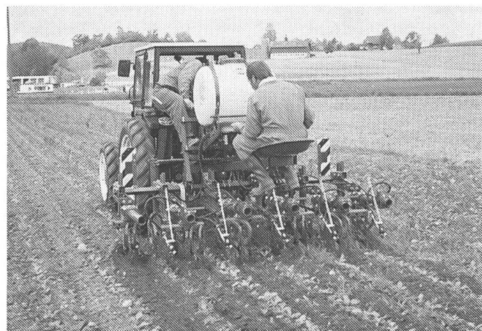
Fig. 3: La sarcleuse soleil avec socs d'ameublissement et deux jeux de soleils par rangée a un très bon effet d'émottage, de retournement et d'enfouissement. A partir de 8 - 10 feuilles, les betteraves sont légèrement butées.
