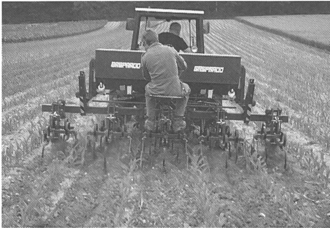
Fig. 9: Avec la sarcleuse à socs (avec distributeur d'engrais en lignes) et un bon réglage des socs sarcleurs, on a obtenu une bonne qualité de travail pour les deux genres de sols.
