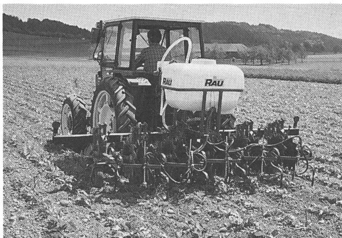
Fig. 2: La sarcleuse à socs I permet d'obtenir une bonne qualité de travail dans les sols tourbeux ou dans les sols minéraux fort pierreux. Les sarcleuses munies de socs en patte d'oie, montés sur ressorts, ont un excellent effet de «mulching» et d'autonettoyage (à droite: sarcleuse à socs II, peut être également utilisée dans le maïs).
