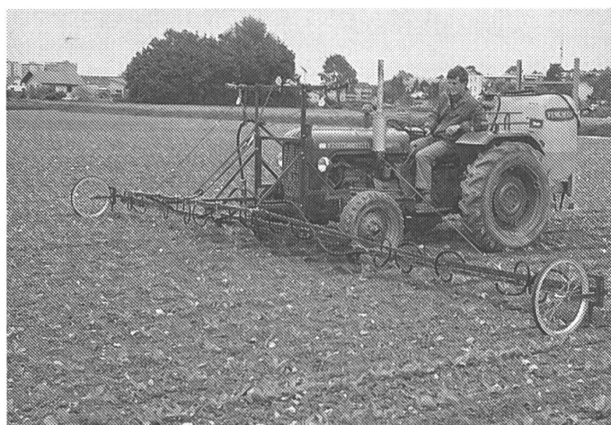
Fig. 8: Une combinaison de pulvérisation par bandes , à 15 rangs sur pulvérisateur pour cultures de plein champ est offert par l'agriculteur M. Käser, 2563 Ipsach au prix de Frs. 2500.-. Cette installation permet d'exécuter des pulvérisations en pré-émergence et en post-émergence en les réglant sur différentes largeurs de rangées. On constate toutefois certains problèmes sur des terrains à fortes pentes et en bout de champ.
