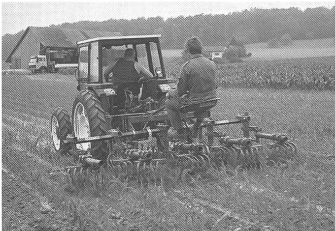
Fig. 10: La sarcleuse soleil à socs sous-soleurs de 28 cm et des soleils en forme de bèches a offert une bonne qualité de travail dans tous les essais. Lors du deuxième sarclage, les mauvaises herbes ont été éliminées par butées.
