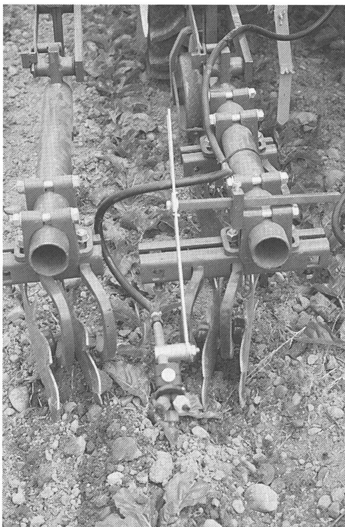
Fig. 3: La sarcleuse soleil avec socs d'ameublissement et deux jeux de soleils par rangée a un très bon effet d'émottage, de retournement et d'enfouissement. A partir de 8 - 10 feuilles, les betteraves sont légèrement butées.
