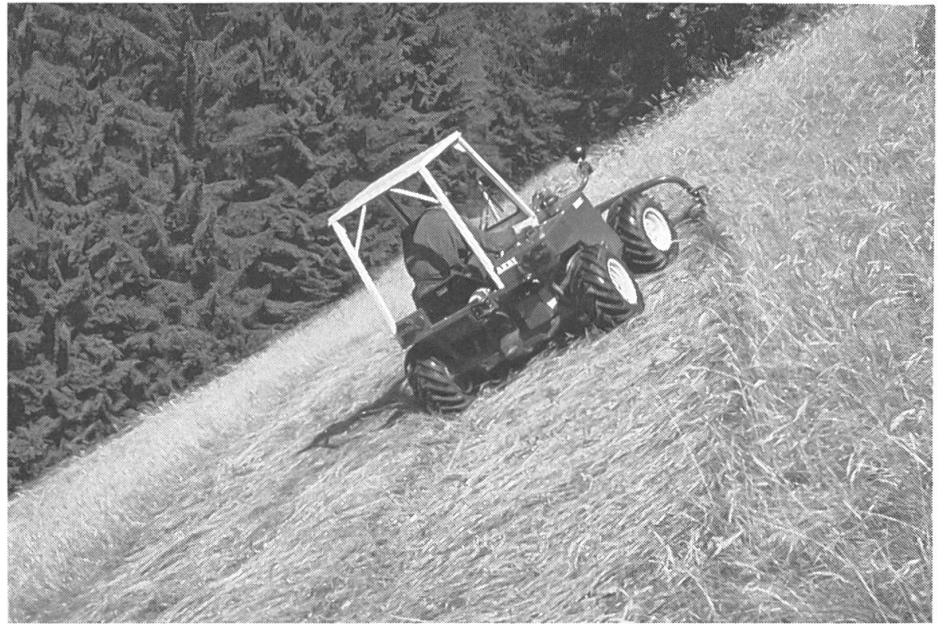
Une faucheuse à deux essieux légère et maniable permet un travail ménageant le sol et sûr.
