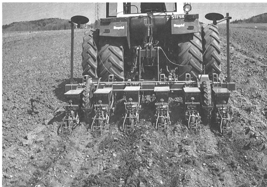
Fig. 10: Le semis sur labour avec un semoir monograine modifié (comparer à la fig. 11) permet d'obtenir des rendements équivalents. Afin de faciliter les travaux d'entretien et de récolte, il convient d'aplanir la surface du sol.
