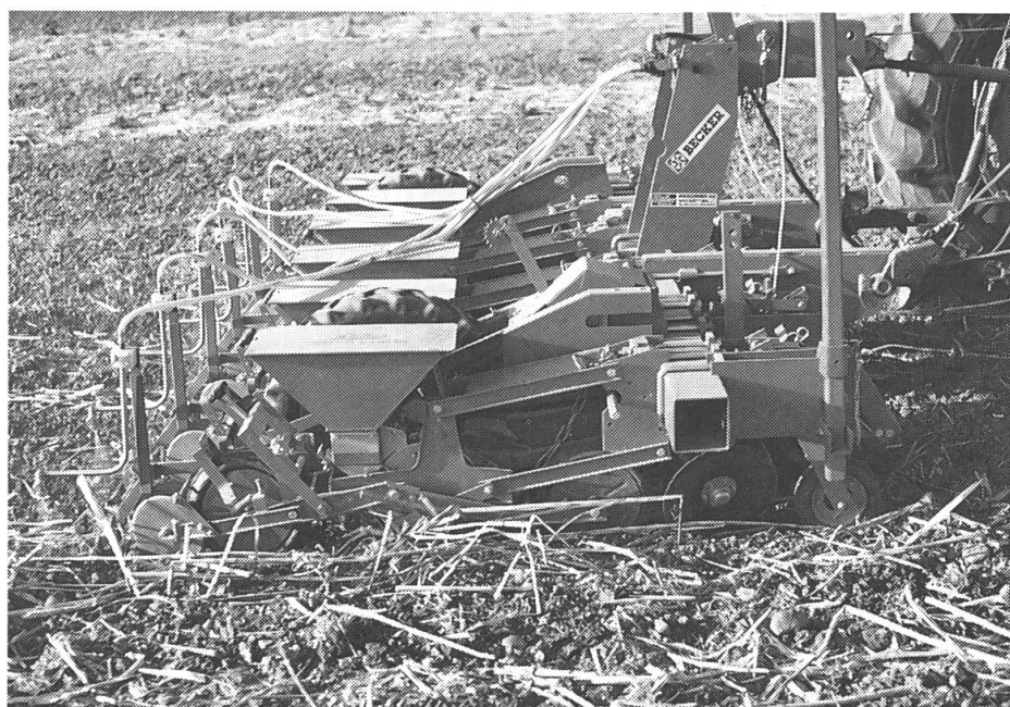
Fig. 11: Pour le semis direct, l'achat d'équipements complémentaires (roue tâteuse, disques écarteurs et de recouvrement, roue plombeuse) pour les semoirs monograinne traditionnels, 6 rangs, occasionne des frais supplémentaires d'environ Frs. 3000.-.
