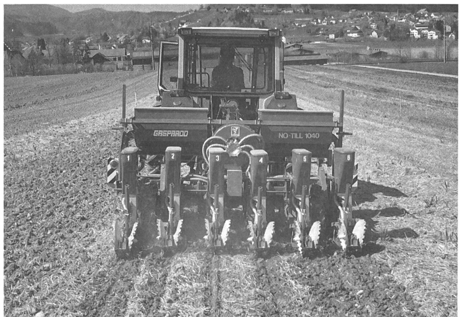
Fig. 8: Avec la méthode de semis combiné à une préparation du sol en bandes, les semences sont déposées dans une bande travaillée d'à peine 10 cm de large. Dans un sol humide, les couteaux coudés peuvent s'avérer néfaste.
