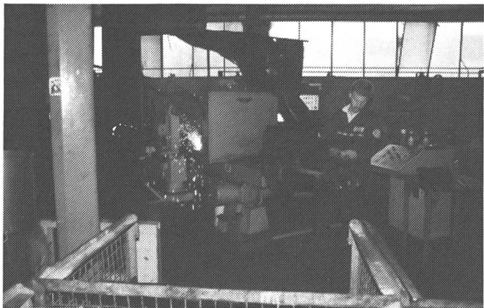
Pendant que le soudeur prépare la prochaine pièce, le robot de soudage, à l'arrière, pose les cordons de soudure avec grande précision.
