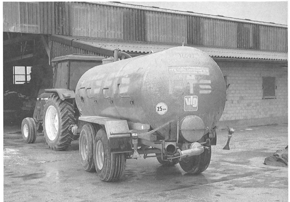
En route avec 10'000 l de purin, au maximum! Depuis le 1 er mai 1989, cela est légal, mais seulement si le poids total de la remorque tandem ne dépasse pas 12 tonnes.
