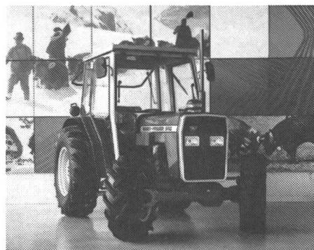
Une nouveauté apportée sur le marché suisse par Massey-Ferguson: le MF 240 4-roues-motrices équipé du moteur diesel 3 cylindres Perkins de 45 CV.
