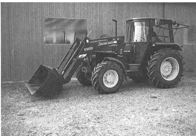
Fig. 1: Il ne faut que quelques minutes, et le chargeur frontal moderne est prêt à être utilisé. L'attelage aussi bien que le démontage se font par un homme seul.
