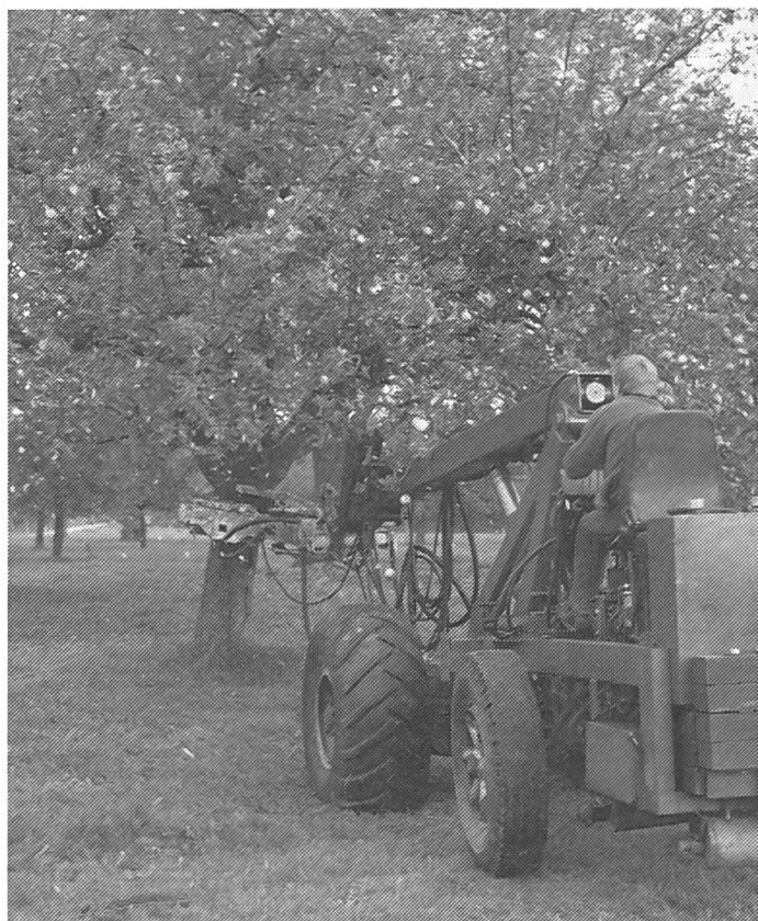
L'organe secoueur long d'env. 3 mètres pèse presque 800 kg. Avec le relevage réglable à l'hydraulique, la pince capitonnée est dirigée de manière optimale vers le tronc d'arbre. Le cylindre hydraulique du milieu accentue la pression nécessaire.
