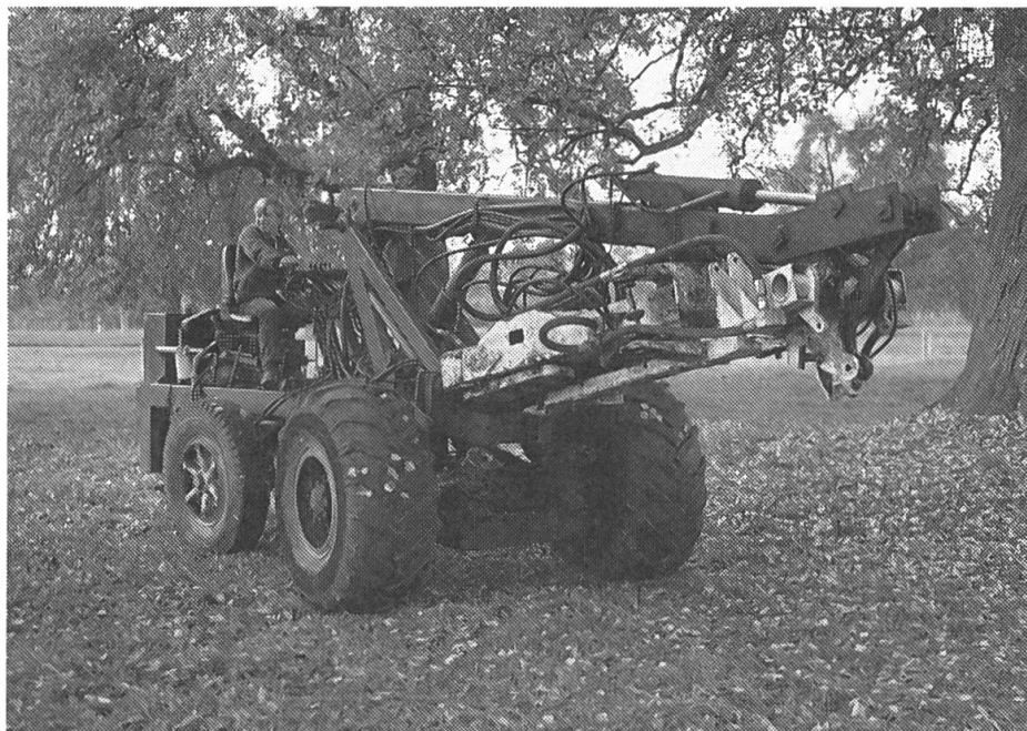
Sa construction étroite et basse permet au véhicule articulé de bouger facilement dans l'allée du verger.
