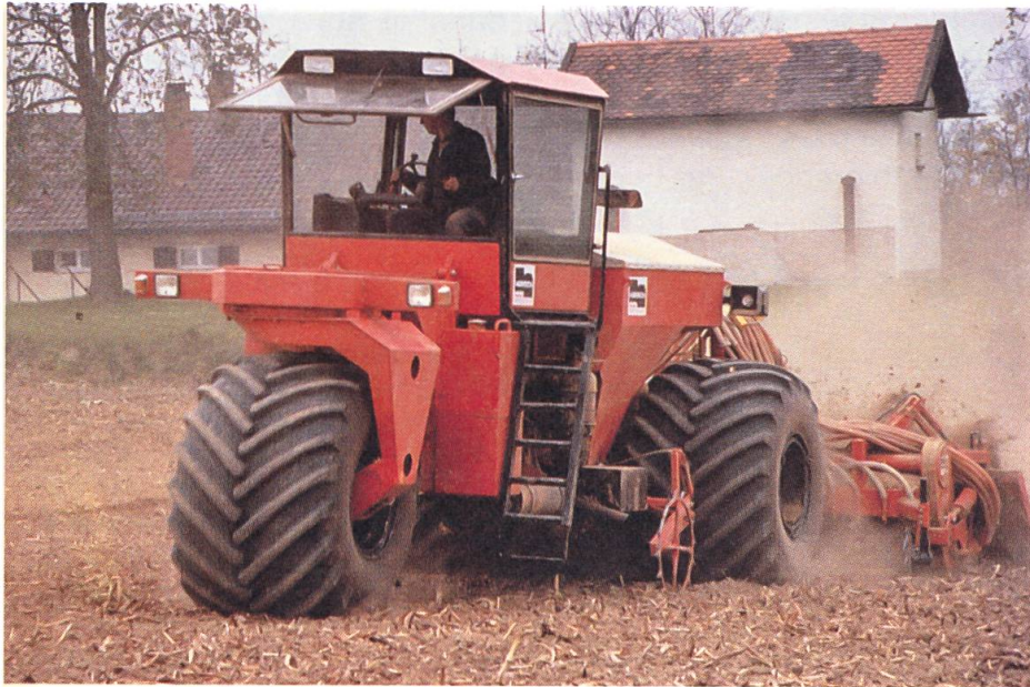
Fig. 2: L'une des extrêmes pour éviter les tassements du sol causés par la mécanisation: diminution de la pression grâce à une réduction du poids du véhicule, respectivement des charges de roue.
