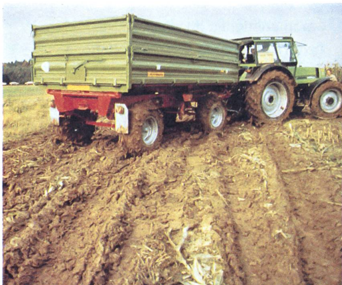
Fig. 1: La prise en considération de l'humidité du sol est décisive pour éviter les tassements du sol. En présence de conditions défavorables, même des véhicules relativement bien équipés occasionnent des dégâts au sol.
