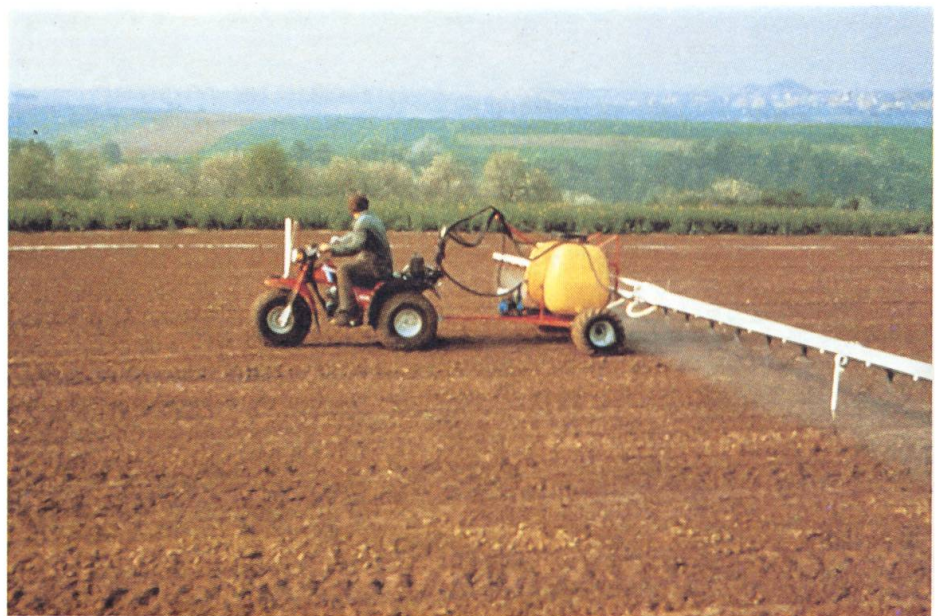
Fig. 3: L'autre extrême pour éviter les tassements du sol causés par la mécanisation: diminution de la surface des traces de passage et augmentation des performances (afin d'exploiter les conditions favorables) grâce à de grandes largeurs de travail. Dans cet exemple, on essaie de limiter les répercussions du poids élevé nécessaire du véhicule par une répartition équilibrée de l'ensemble du poids sur toutes les roues ainsi que par des pneumatiques adéquats.
