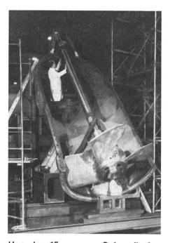
Une des 15 pompes Sulzer livrées à l'Egypte pour le système d'irrigation El Omoun.
