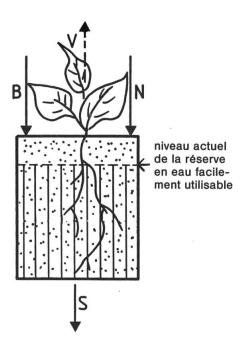
Figure 1: Le sol est un réservoir d'eau facilement utilisable; les pertes interviennent par évaporation (V) et percolation (S); les apports sont constitués par l'arrosage (B) et les précipitations (N).
