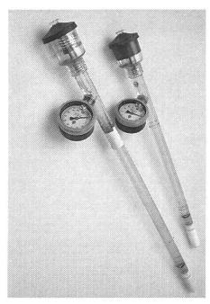
Figure 3: tensiomètre équipé d'un manomètre de dépression et d'un réservoir d'eau.
